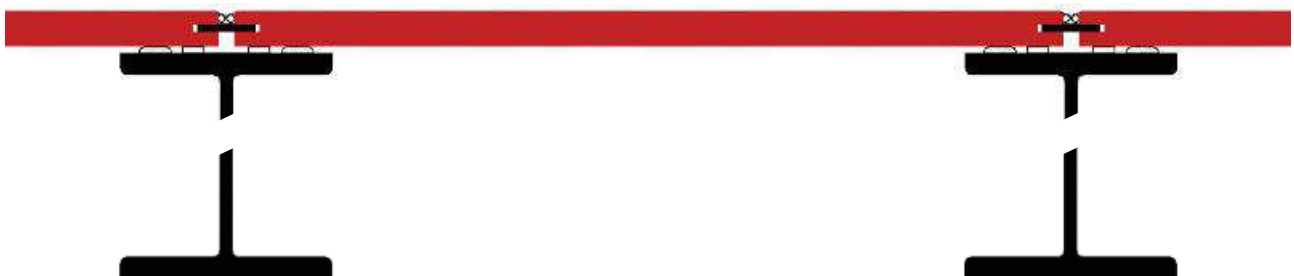
Balkonbodenplatte auf Stahlträger verdeckt befestigt (geklebt)
