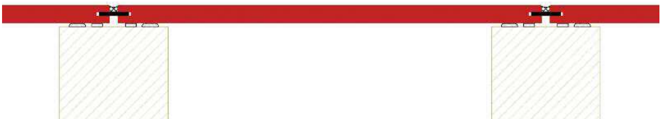
Balkonbodenplatte auf Holztram verdeckt befestigt (geklebt)
